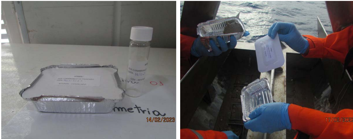
Figura 3-7: Coleta de amostras controle (branco de campo e branco de frascaria) para o compartimento sedimento.
