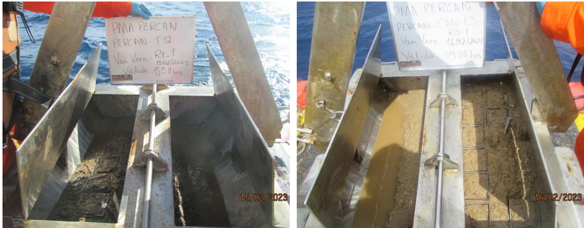
Figura 3-6: Coleta de amostras de sedimento.
