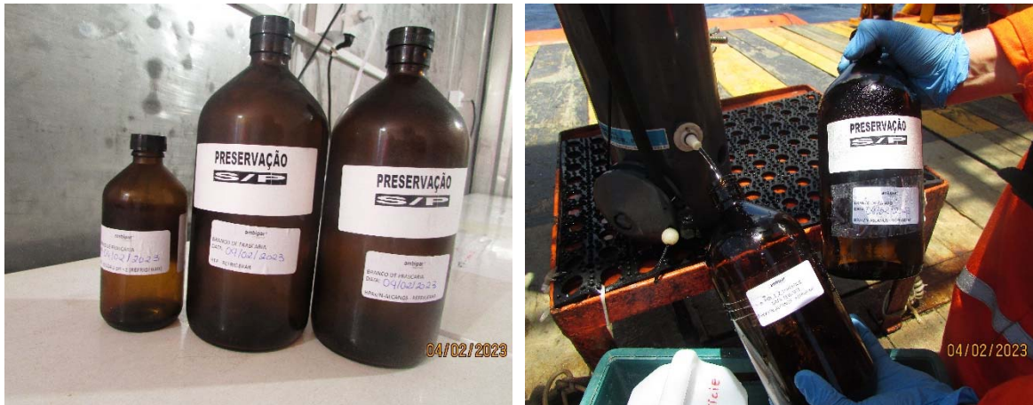
Figura 3-4: Coleta de amostras controle (branco de campo e branco de frascaria) para o compartimento água.
