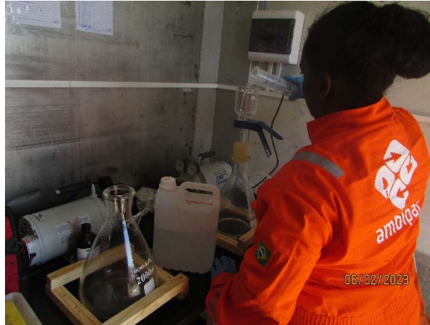
Figura 3-3: Filtragem a bordo para análise dos parâmetros MPS e COP.
