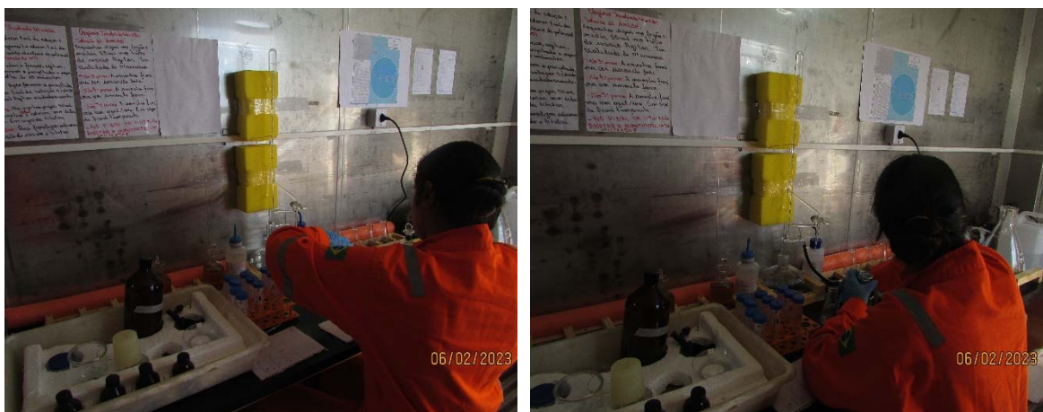
Figura 3-2: Determinação de Oxigênio Dissolvido (OD) pelo método de Winkler .
